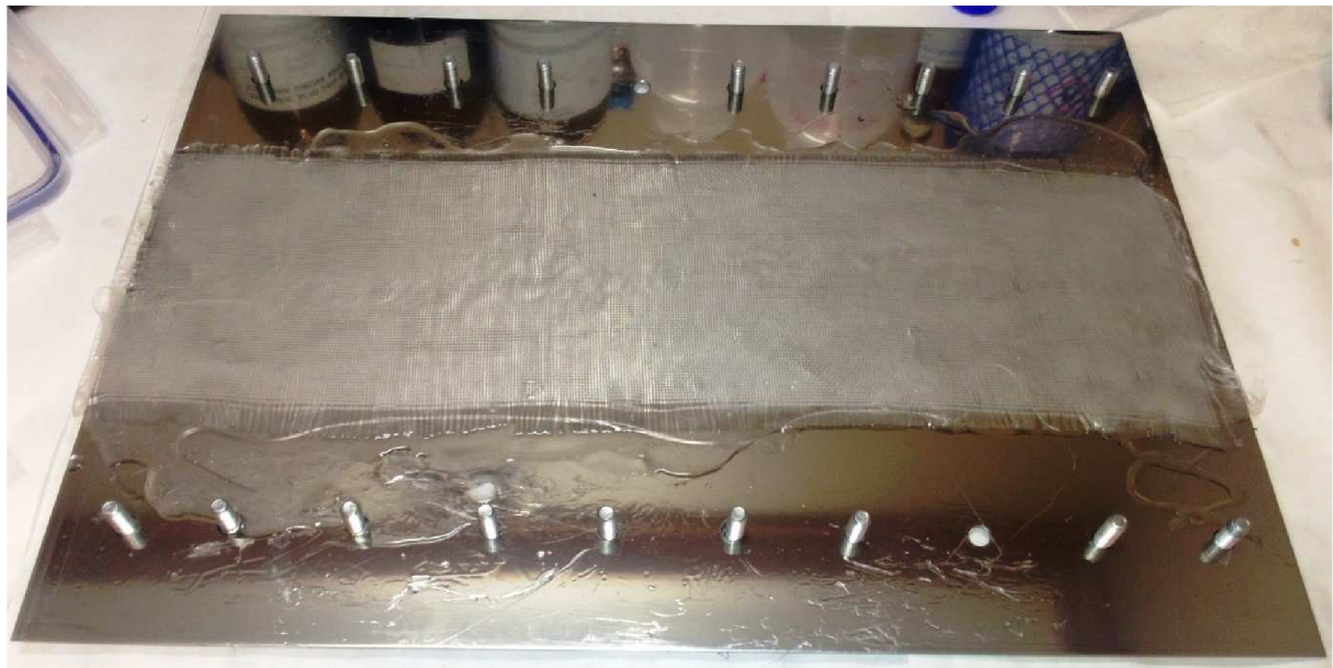
Obr. 7: Roztok PMMA v monomeru a tkanina před vytvrzením
