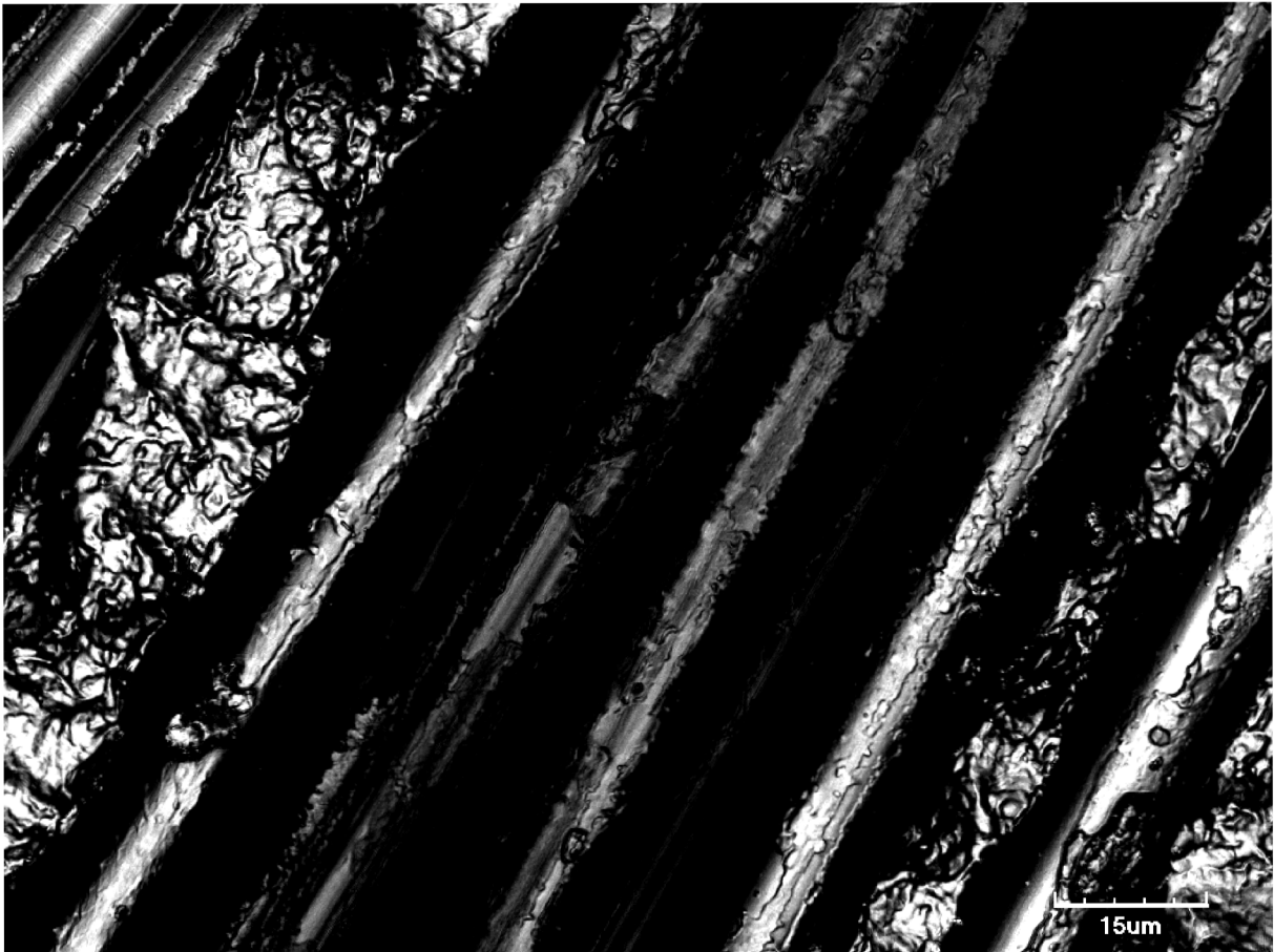
Obr. 21: Adheze matrice k výztuži
