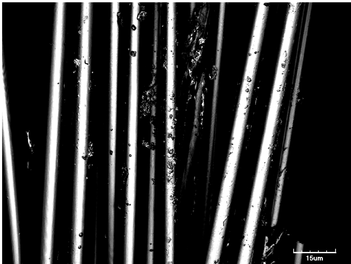
Obr. 22: Adheze matrice k výztuži (2)
