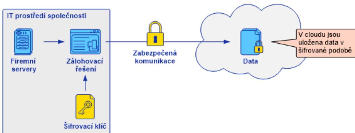
Obrázek 4: Princip zabezpečeného ukládání dat v cloudu (Puš, 2015)
