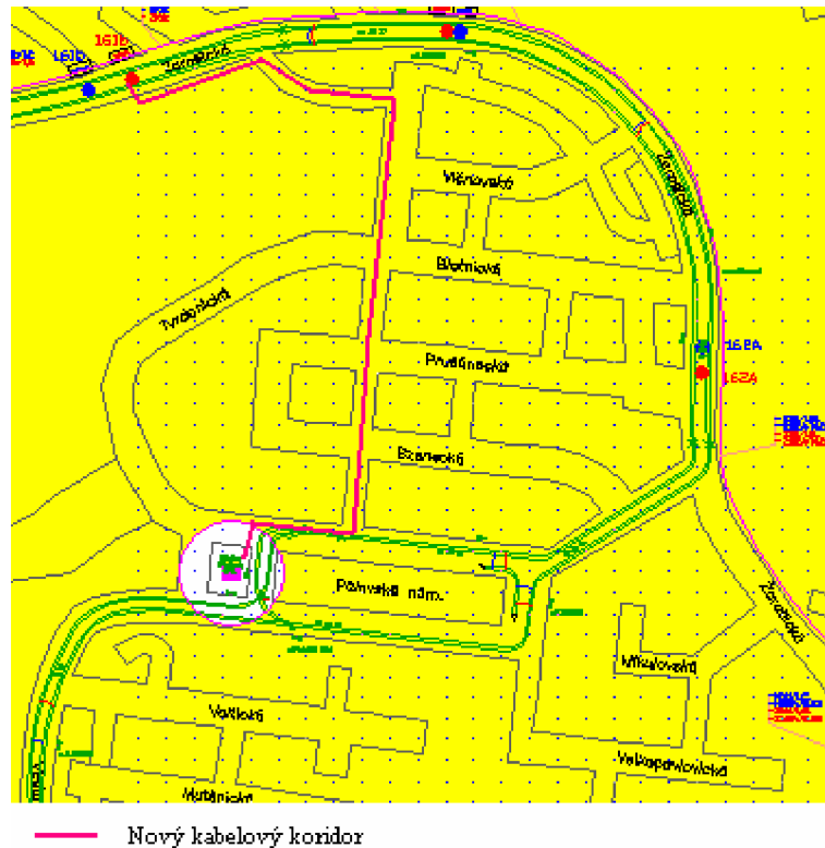
Obrázek 5-1 Návrh nového kabelového koridoru.
