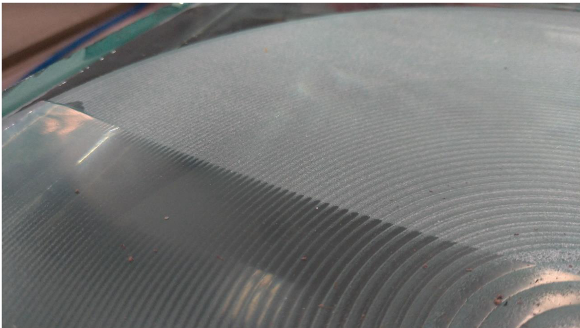
Obr. 2 Ukázka povrchu před a po broušení
