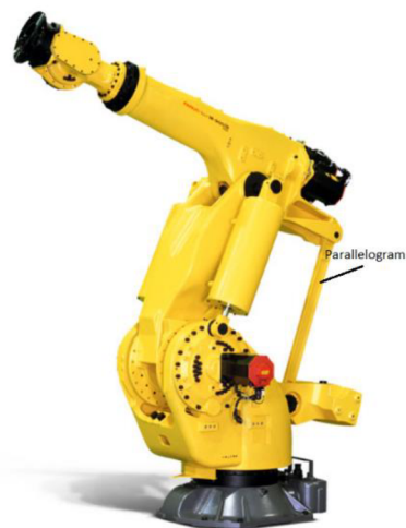
Obr. 5 Kvazi – sériový robot Fanuc M-900iB/700 [30]
