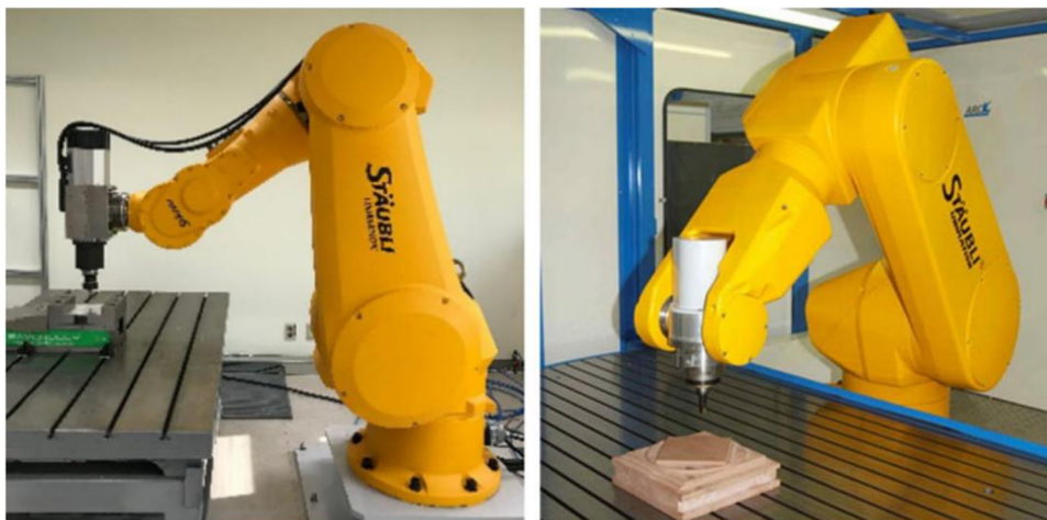
Obr. 6 Upnutí koncového efektoru v 6 kloubu (vlevo) a upnutí v 5 kloubu (vpravo) [20].
