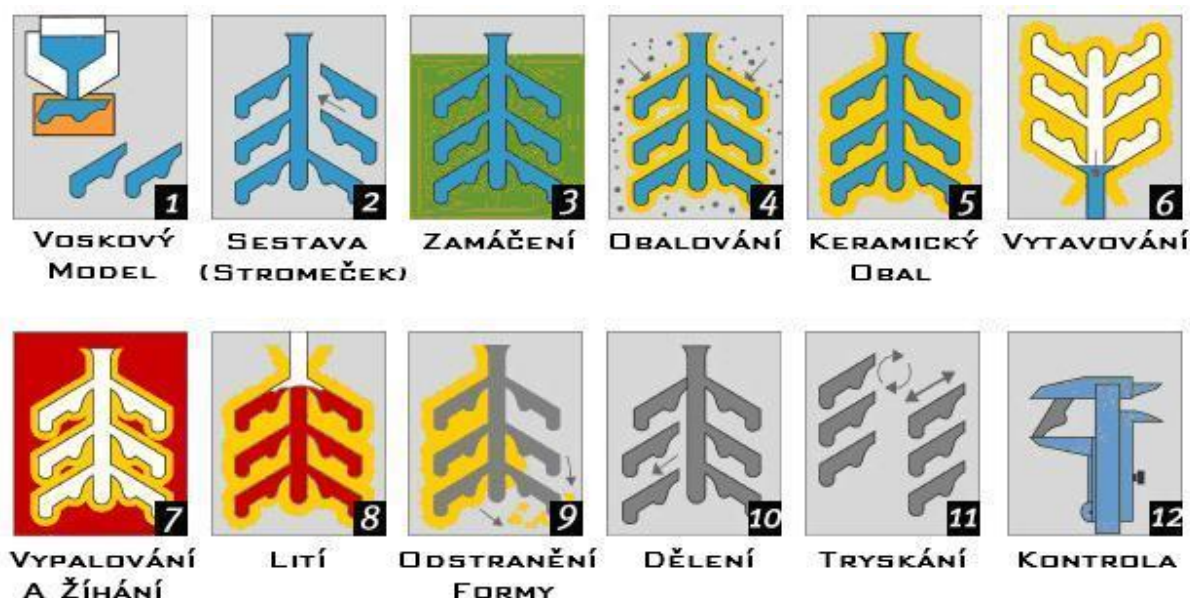
Obr. 7) Proces výroby vytavitelného modelu [15]
