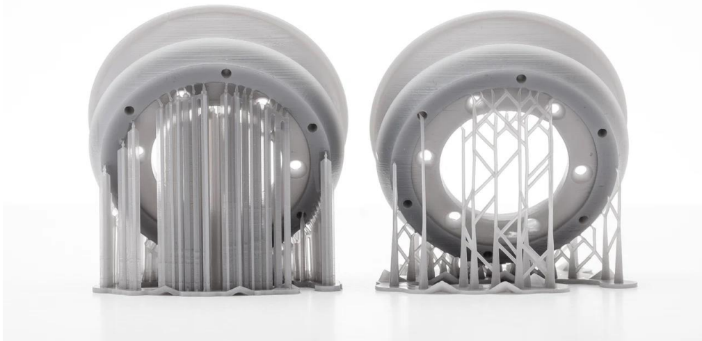
Obr. 20) Příklad podpor u SLA tisku [55]
