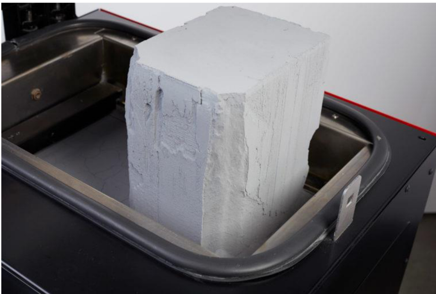
Obr. 21) Obsah tiskového lože po dokončení tisku u SLS tiskárny [56]
