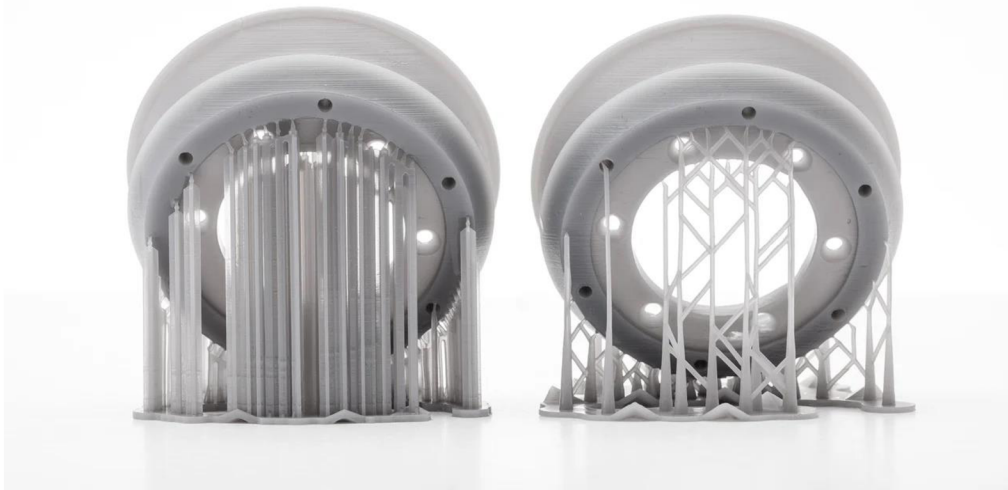
Obr. 20) Příklad podpor u SLA tisku [55]
