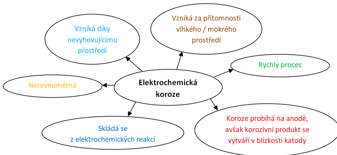
Obr. 1-3 Hlavní charakteristika elektrochemické koroze [11]
