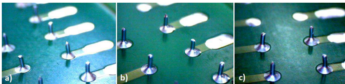
Obr. 6-27 Vzhled pájených spojů u THT součástek, a) tavidlo 3, b) tavidlo 4, c) tavidlo 6
