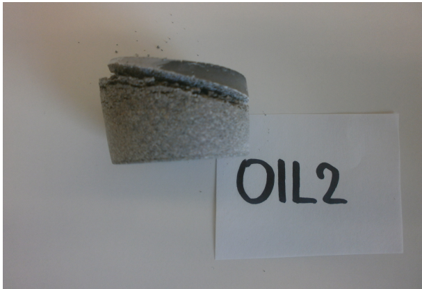
Obr. 24 – Oddělená krusta (aktivátor + struska) od usazeného popílku u vzorku OIL2
