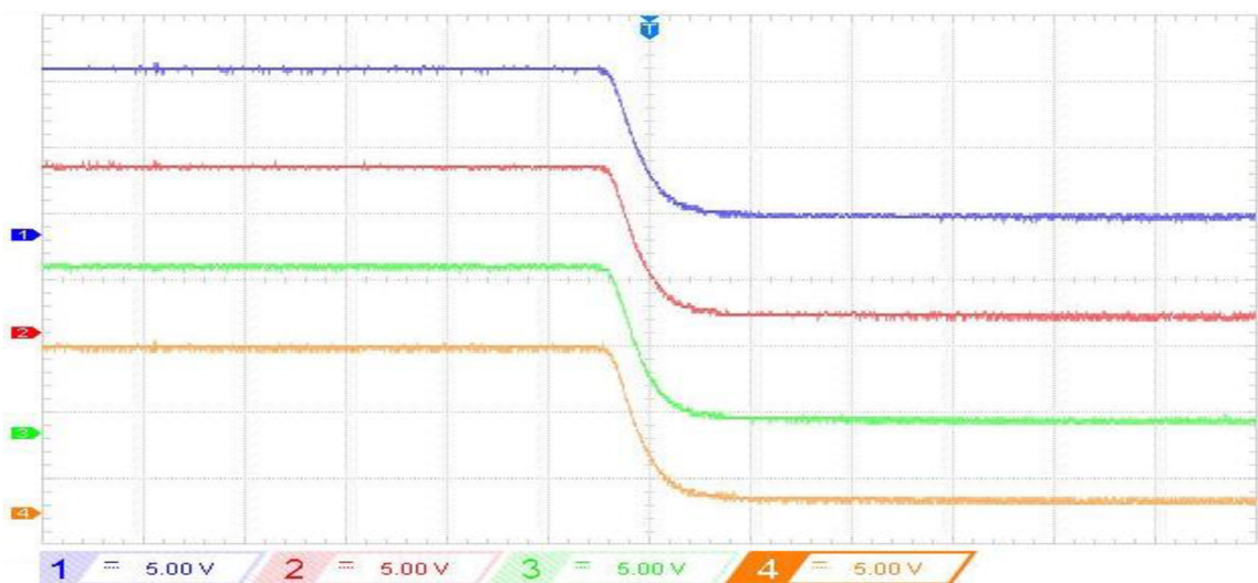
Obr.4.3-2 Priebeg riadiacich pulzov dobežaná hrana časová konštanta 1\mu\text{s}
