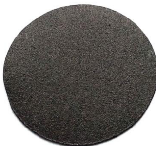
Obr. 28: Vyrobená elektroda z přírodního grafitu 280 H nelisovaná
