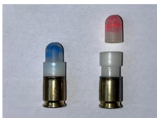
Obrázek 17 - FX Simunition (vlevo nevystřelený náboj a vpravo vystřelený náboj)
