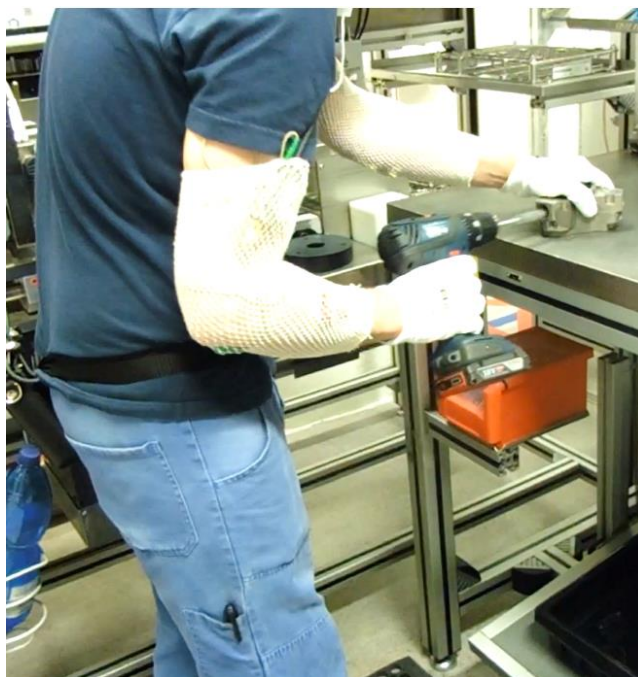
Obr. 13) Očištění otvoru [fotoarchiv autora]
