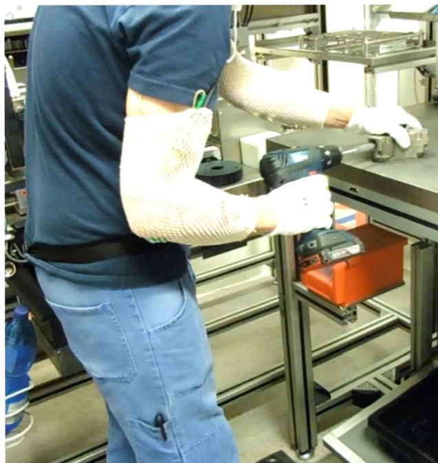
Obr. 13) Očištění otvoru [fotoarchiv autora]
