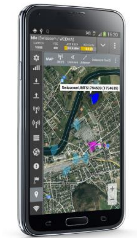
Obr. 5.3: Systém QualiPoc Android užívaný pro stacionární měření [25].
