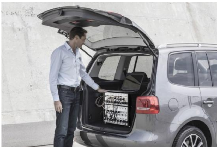
Obr. 5.1: Umístění systému Diversity Benchmarker II v měřicím voze [25].
