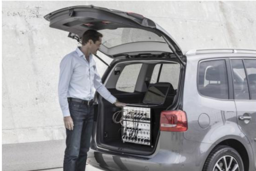
Obr. 5.1: Umístění systému Diversity Benchmarking II v měřicím voze [25].
