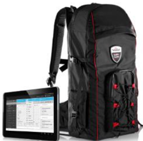
Obr. 5.2: Systém QualiPoc Freerider II pro pěší měření [25].
