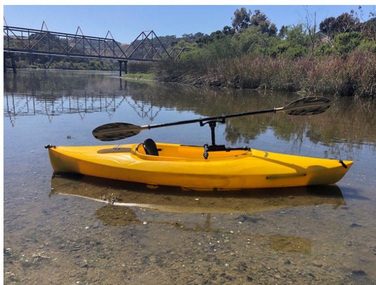
Obrázek 3. Držák na kajakářské pádlo s upevněním v horní části kajaku ( www.angleoar.com )
