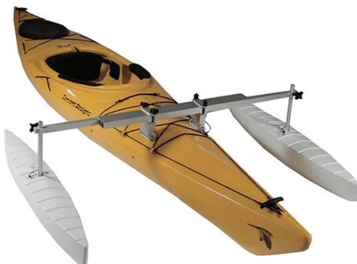
Obrázek 12. Stabilizátory upevněné na kajaku ( www.angleoar.com )
