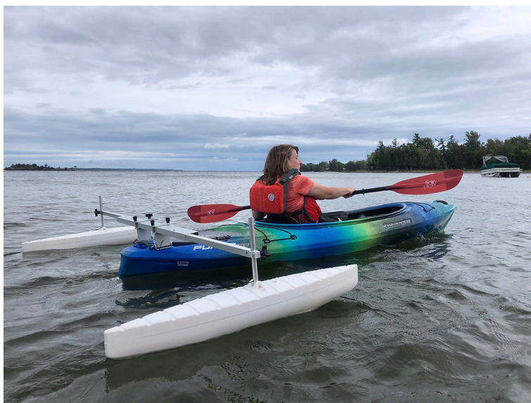
Obrázek 11. Stabilizátory upevněné na kajaku ( www.angleoar.com )
