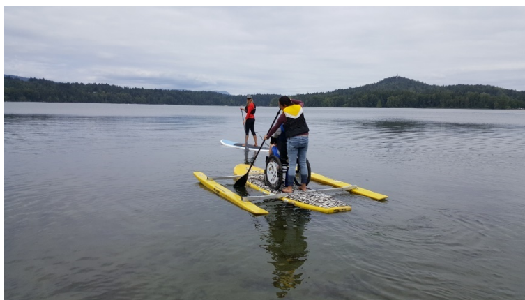
Obrázek 42. Speciální paddleboard s plováky a surfařským invalidním vozíkem na vodě ( www.accessrevolution.com )
