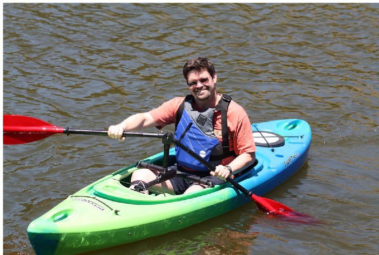
Obrázek 1. Adaptivní kajakářské pádlo připevněné na kajaku ( www.angleoar.com )
