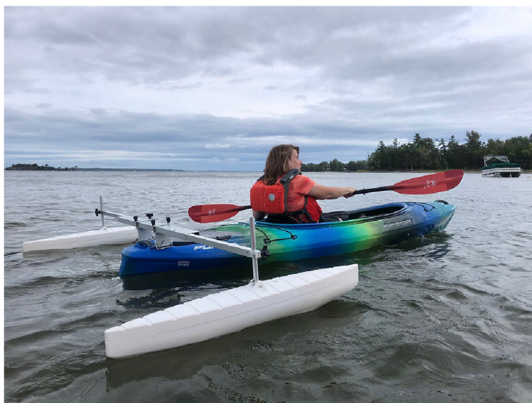
Obrázek 11. Stabilizátory upevněné na kajaku ( www.angleoar.com )
