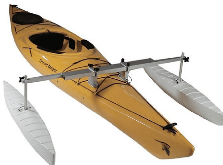
Obrázek 12. Stabilizátory upevněné na kajaku ( www.angleoar.com )
