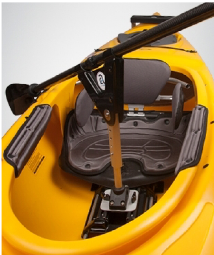
Obrázek 5. Držák kajakářského pádla s otočnou hlavicí a upevněním uvnitř kajaku ( www.americancanoe.org )
