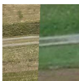
Obr. 13 a Obr. 14: Porovnání přesnosti a ostrosti dlaždic (parametry: PNG, maximální dostupná kvalita obrazu, bilineární metoda převzorkování, zoom 20). Software zleva doprava – GDAL2tiles, QTiles. (Zdroj podkladových dat: GEODIS Brno, 2018)
