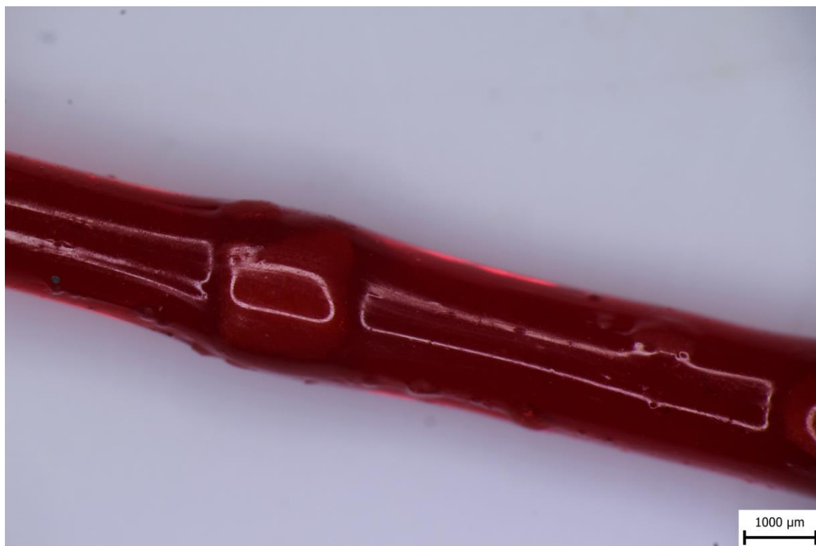
obr. 6-4 Neroztavený kousek materiálu uprostřed filamentu
