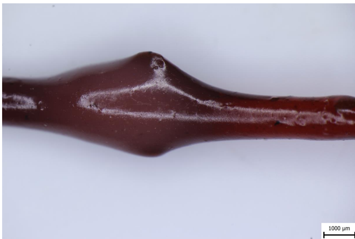
obr. 6-1 Znehodnocení filamentu kvůli příměsím
