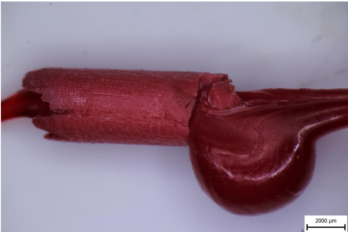
obr. 6-3 Zatvrdlý filament v trysce
