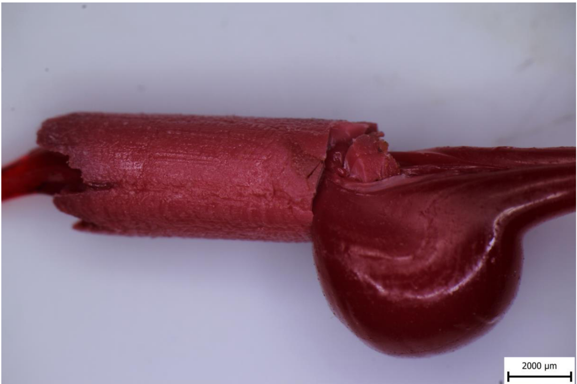
obr. 6-3 Zatvrdlý filament v trysce
