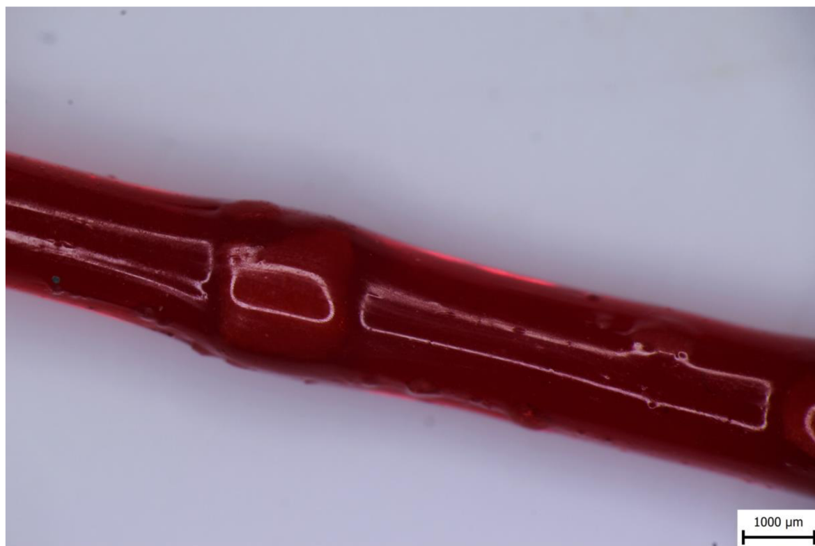
obr. 6-4 Neroztavený kousek materiálu uprostřed filamentu
