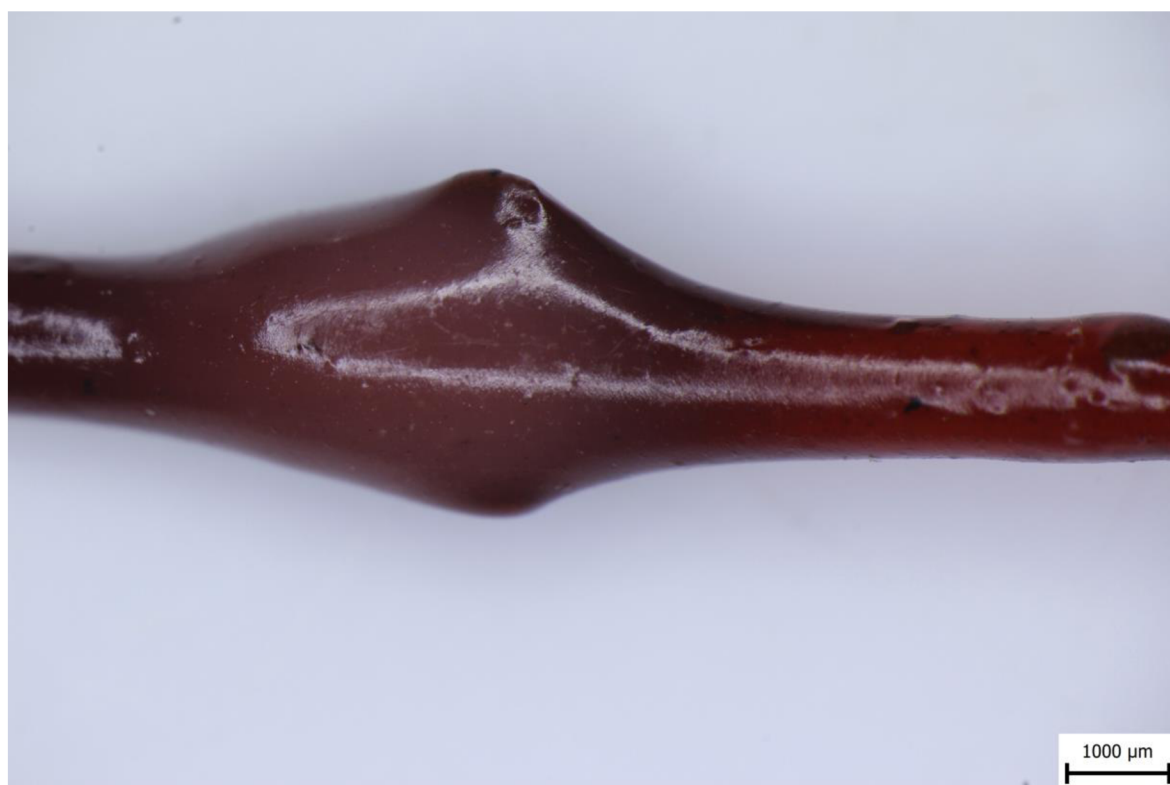
obr. 6-1 Znehodnocení filamentu kvůli příměsím
