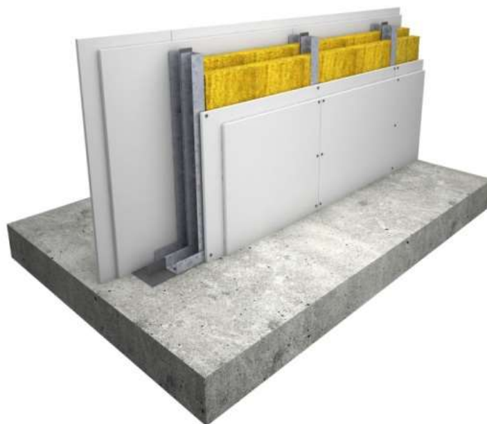
Obrázek 25 Skladba sádrokartonové příčky u výtahu
