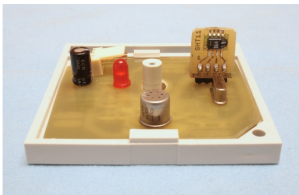
Obr. 17: Modul měření čistoty vzduchu: pohled z přední strany (vlevo), pohled za strany součástek (vpravo)
