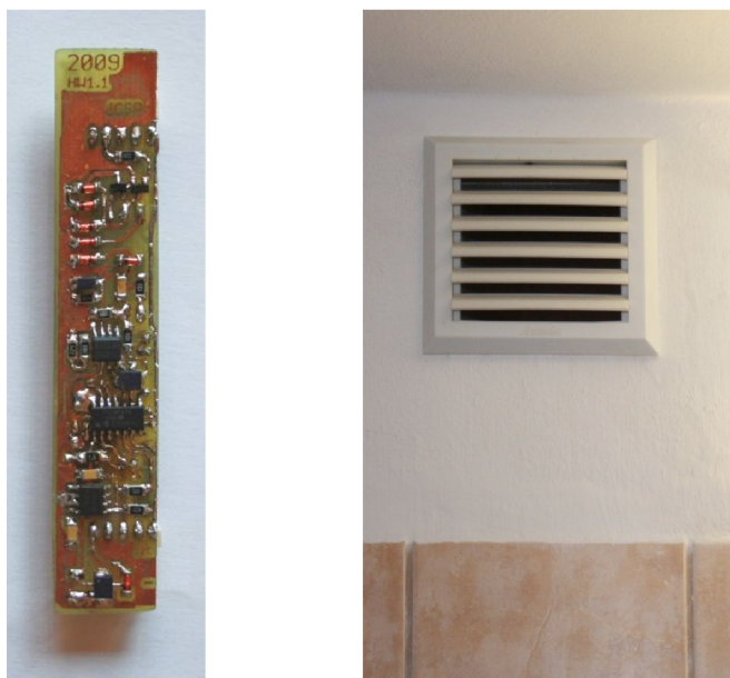
Obr. 39: Modul regulace vlhkosti (vlevo), ventilační mřížka (vpravo)
