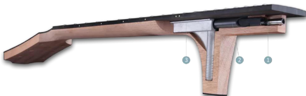
Obr. č. 40 – Výztuha krku kytary Furch 1 – kovová tyč, 2 – karbonová trubice do které se tyč umísťuje (karbon pevnost), 3 – Hliníková vložka patky (furchguitars.com).
