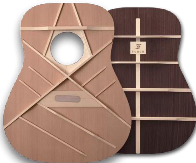
Obr. č. 14 – Žebrování přední ozvučné desky a zadní desky kytary Furch s kovovými strunami (furchguitars.com)
