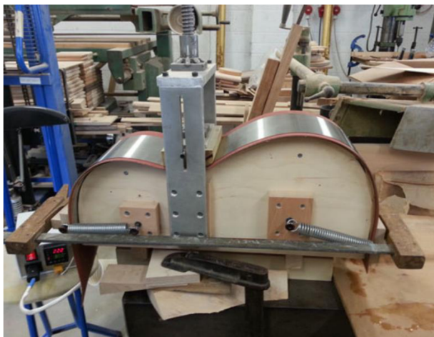
Obr. č. 12 – Ohýbání a tvarování napařených plastifikovaných lubů (Bennett, 2016)
