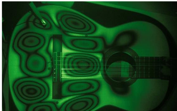
Obr. č. 33 – Metoda holografické interferometrie (compadre.org).
