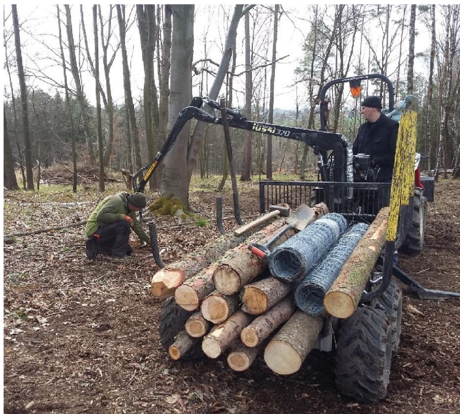
Příloha č. 13: Traktor Branson 2400h, vyvážecí přívěs T2000, půdní vrták (zdroj: vlastní)
