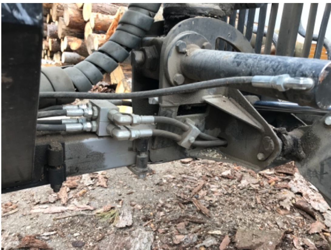
Příloha č. 10: Úprava uchycení hydraulické ruky (zdroj: vlastní)
