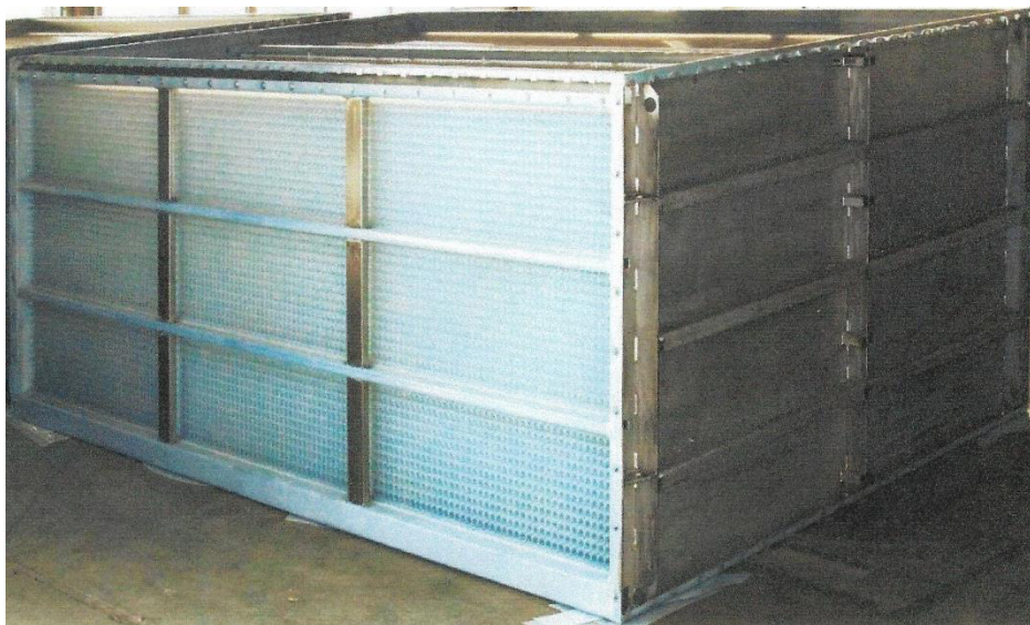
Obrázek 17 Sklotrubkový výměník W401 (1)
