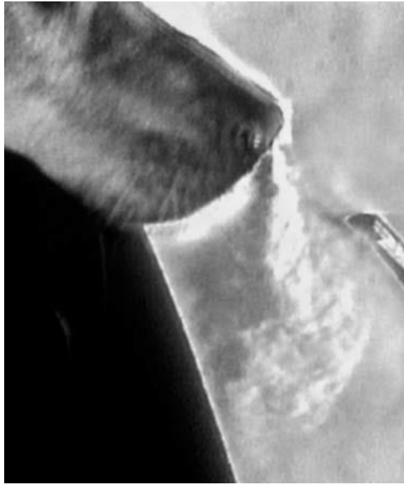
Obrázek 3: Schlierenův obraz znázorňující orientaci turbulentních vzduchových proudů z nozdry psa (černým předmětem je opěrka hlavy, zdroj pachu je držen kleštěmi (Settles et al., 2003)
