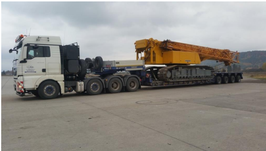
Obrázek 42: MAN TGX 41.540 a podvalník Goldhofer STZ-VL4-55/80A [14]
