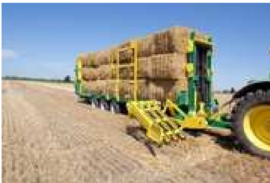
obr.12 Sběr balíků samosběracím vozem
