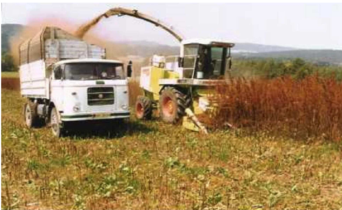
obr.11 sklizeň šťovíku sklízecí řezačkou
