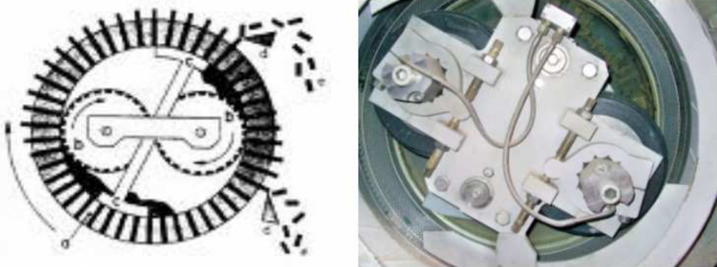
obr.6 Prstencová matrice se dvěma rolnami
