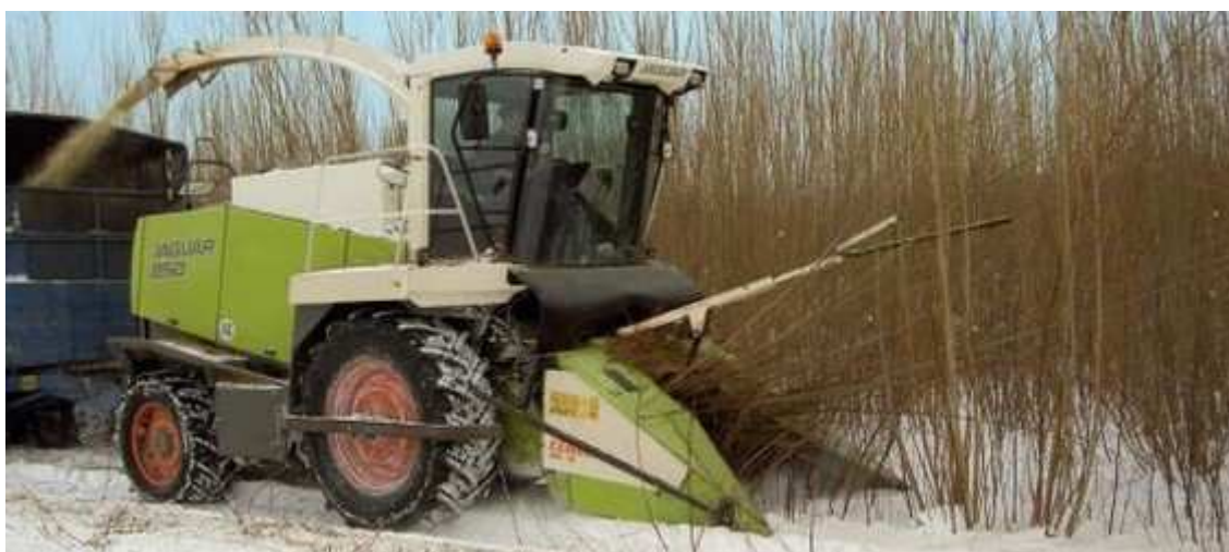
obr.17 Sklizeň rychlerostoucích dřevin upravenou sklízecí řezačkou
