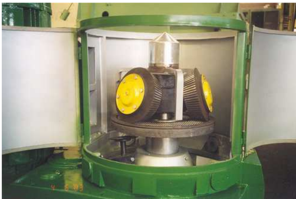
obr.5 Pohled na horizontální matrici se třemi rolkami
