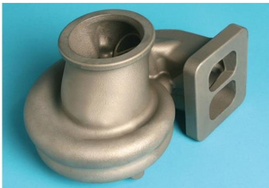
Obr. 34 Odlitek pláště turba [45]
