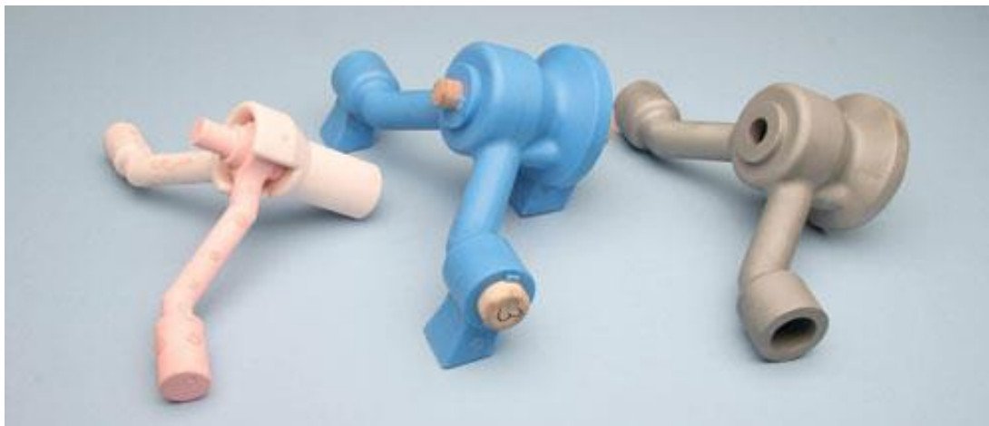
Obr. 31 Keramické jádro, voskový model s keramickým jádrem a hotový odlitek [42]
