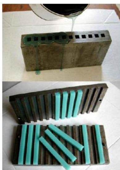
Obr. 9 Forma na zkušební tyčinky [25]
