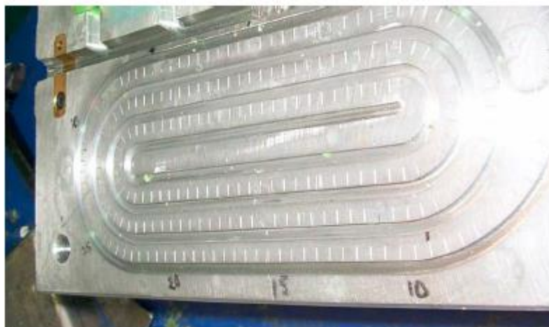
Obr. 12 Forma pro zkoušku zabíhavosti [23]
