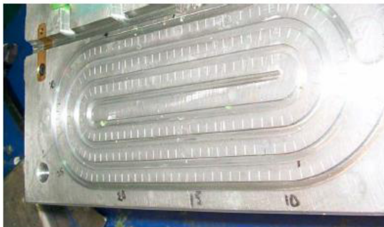
Obr. 12 Forma pro zkoušku zabíhavosti [23]
