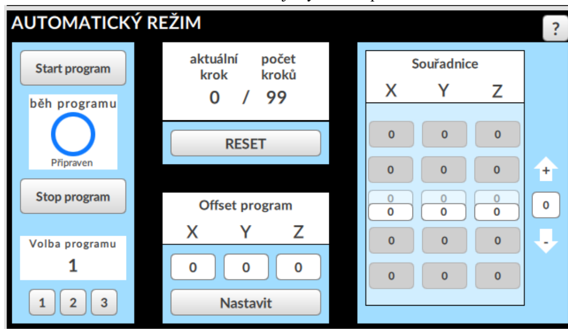
Obrázek 5.5 Panel automatického režimu
