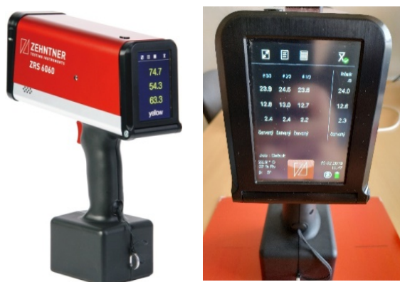
Obr. 20: Měřič retroreflexe Zenther 6060
