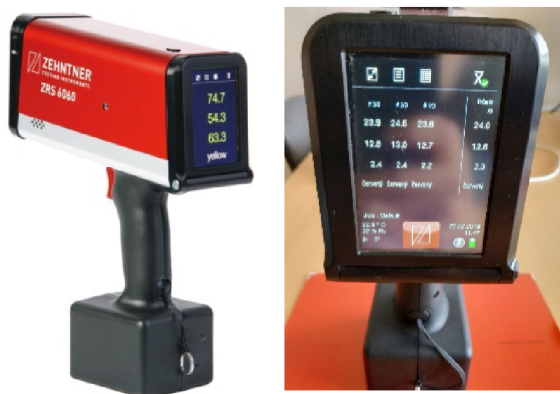
Obr. 20: Měřič retroreflexe Zenther 6060
