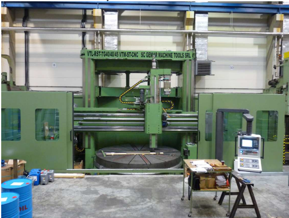
Obr. 3.2. Dvoustojanový svislý soustruh [14]
