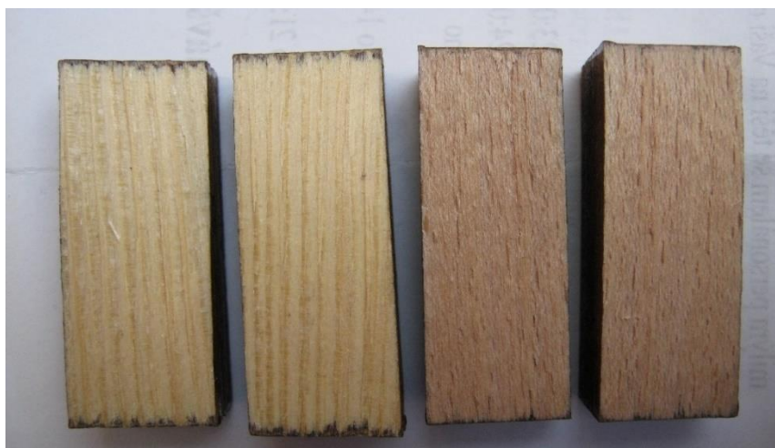
Obrázek 19: Rozdíl v příjmu látky mezi borovicí (vzorky vlevo) a bukem (vzorky vpravo)
