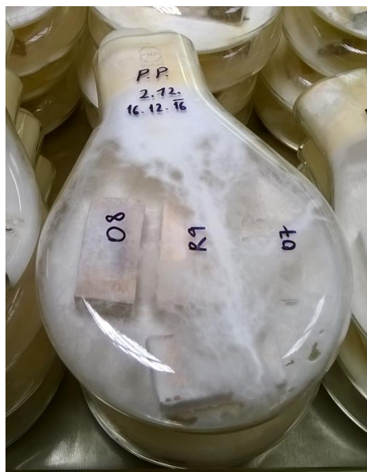
Obrázek 12: Vzorky v Kolleho baňce po 16 týdnech, porostlé myceliem
