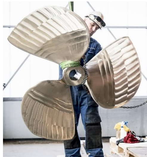
Obr. 21: Lodní šroub vyrobený pomocí WAAM [28]
