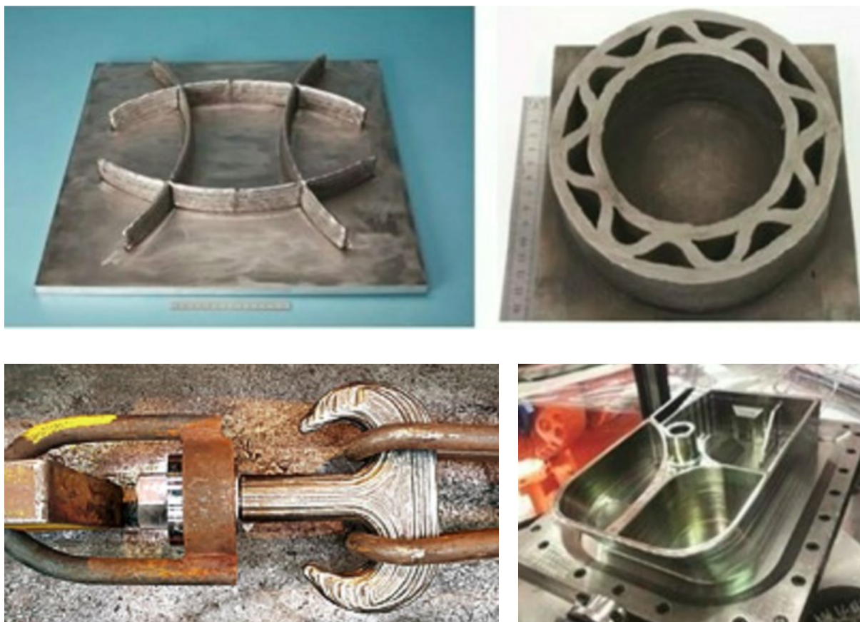
Obr. 1: Ukázky 3D tisku nahoře dvě struktury, dole vlevo lodní hák, vpravo forma [2], [3]
