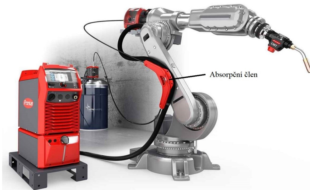
Obr. 28: Robotická sestava pro svařovací proces CMT [27]
