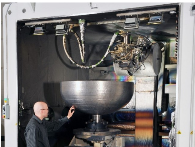
Obr. 44: Kopule palivové nádrže [42]
