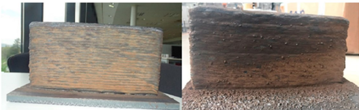
Obr. 41: Stěna vytisknutá pomocí PAW vlevo, pomocí GMAW vpravo [41]
