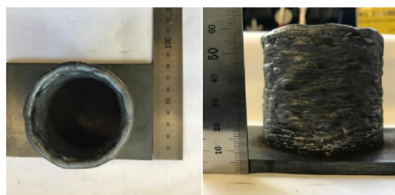
Obr. 30: Návar pomocí MAG [29]
