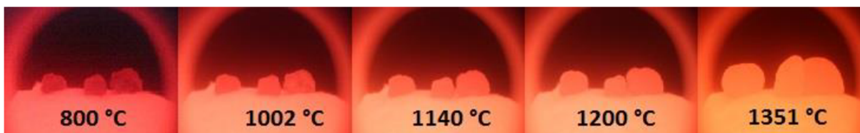
Obrázek 17: Zrna strusky s Oslavan v pozorovací peci
