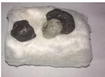
Obrázek 18: Zrna strusky z Oslavan po teplotní expozici v pozorovací peci
