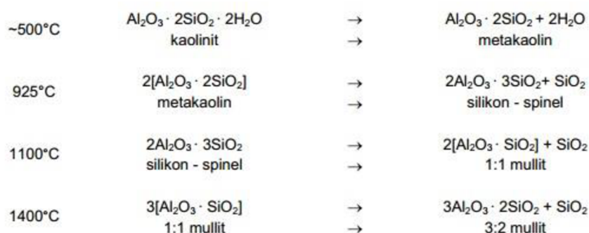
Obrázek 11: Schéma kalcinace kaolinitu [14]
