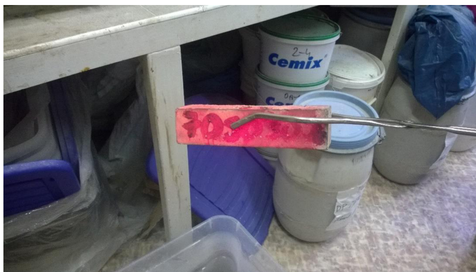
Obrázek 21: Rozžhavený zkušební trámeček vytažený z pece při teplotě 1000 °C
