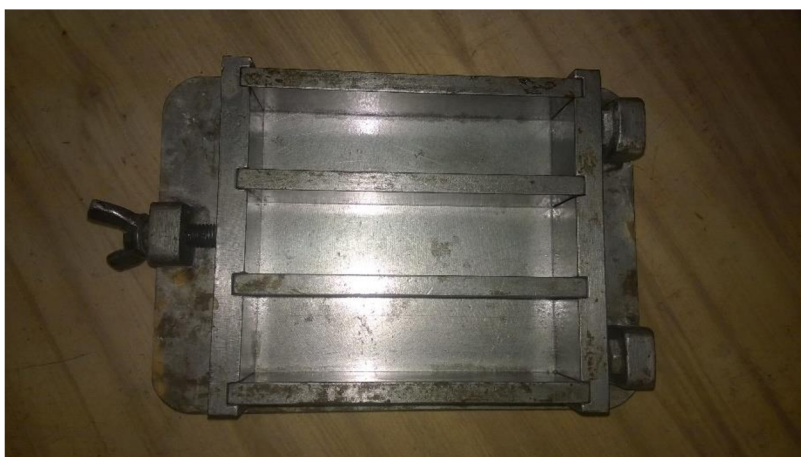
Obrázek 19: Ocelová forma 40 x 40 x 160 mm pro výrobu těles z etapy III
