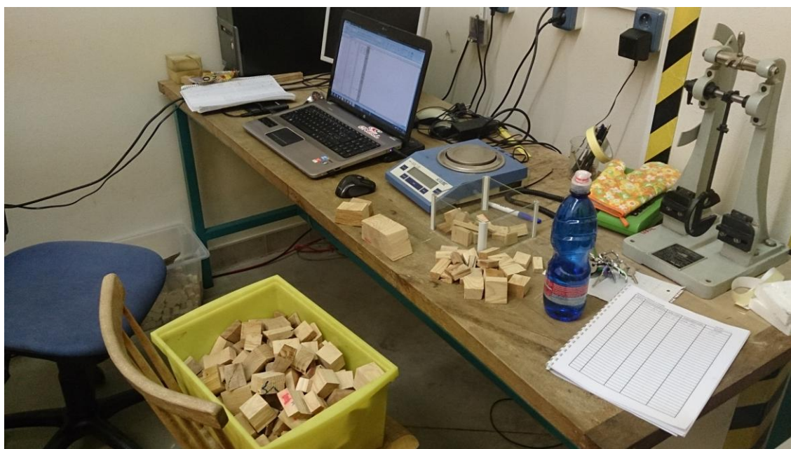
Obr. 12: Pracoviště pro vážení absolutně suchých vzorků a následný výpočet konvenční hustoty
