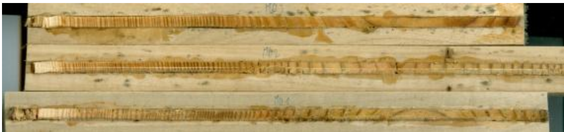
Obr. 5: Vývrty vlepené do lišt a připravené k měření
