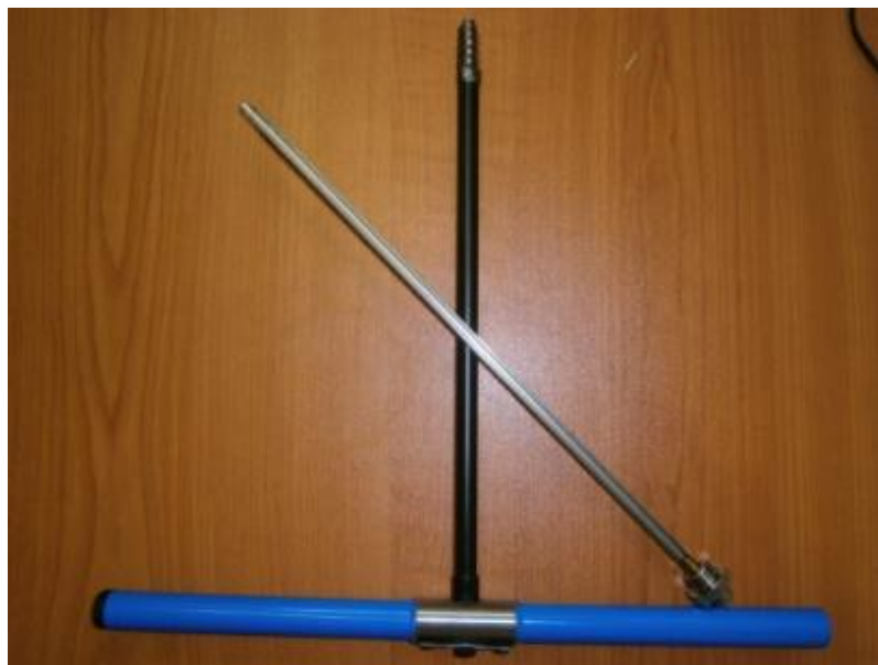
Obr. 4: Presslerův přírůstový nebozez
