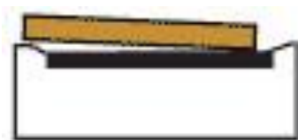
Obr. 3: Nevhodný papírenský skener s vyvýšenými okraji (Image Analysis for Plant Science, 2016)
