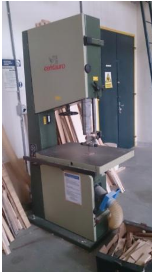
Obr. 8: Pásová pila pro vymanipulování vzorků z příčných kotoučů
