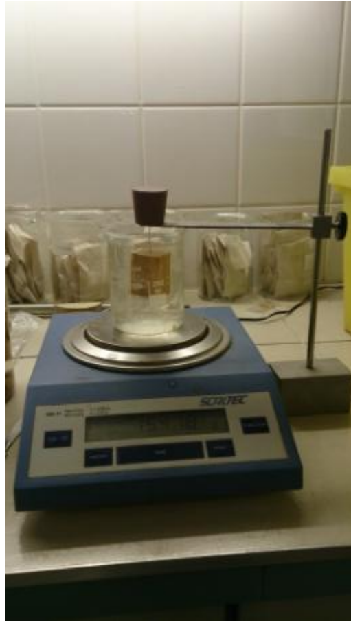
Obr. 10: Laboratorní váha Scartek SBC 41 a speciální stojan pro určení objemu vzorku
