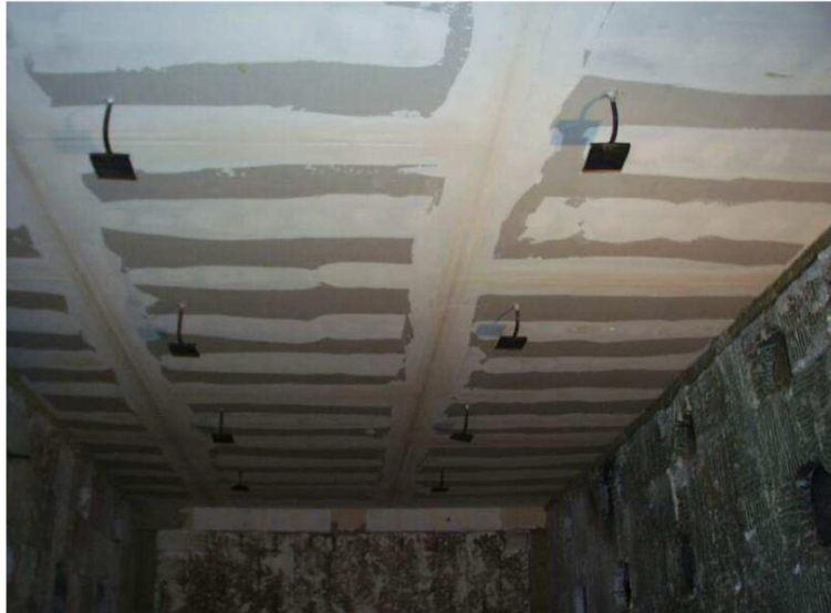
Obr. 3.3 Stav stropu pred zahájením požiarnej skúšky - podľa literatúry (12)
