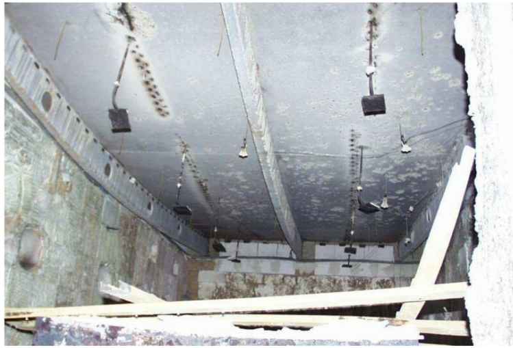
Obr. 3.5 Stav stropu po skúške - podľa literatúry (12)
