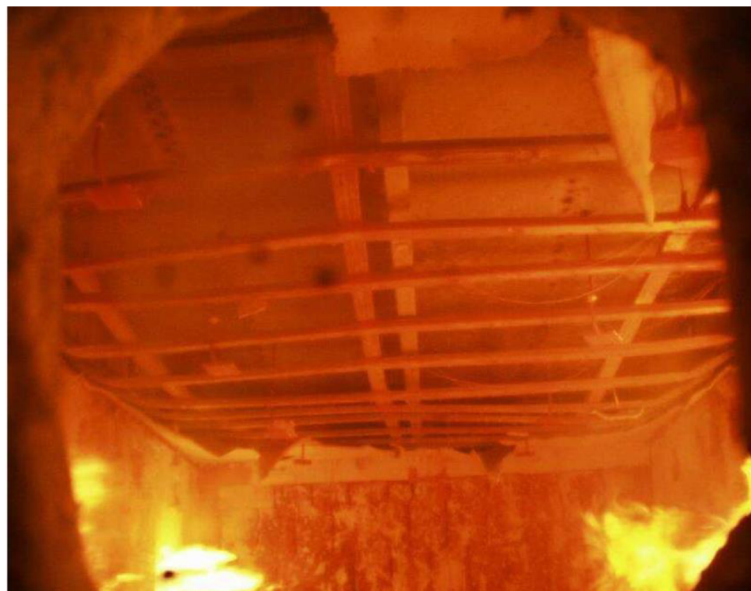
Obr. 3.4 Odpadnutie SDK asi pri 40 min skúšky - podľa literatúry (12)
