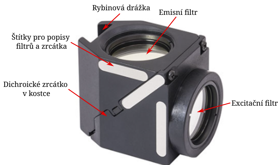
Obrázek 6.2: Fluorescenční kostka TLV-U-MF2-TRITC s předinstalovanými filtry a dichroickým zrcátkem pro fluorofor TRITC od firmy Thorlabs. Převzato a upraveno z [27].
