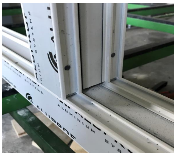
Obr. 1.13 Princip osazení profilů dělených na 90 °.
