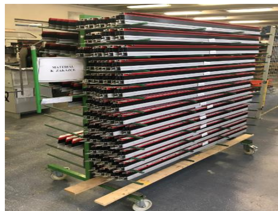
Obr. 1.7 Pojízdný zakladač pro nařezané profily.
