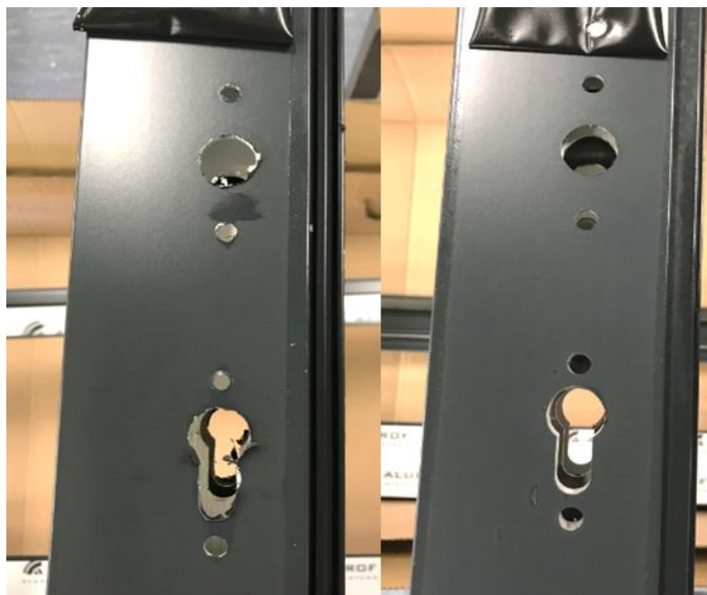
Obr. 4.9 Otvory pro osazení povrchového kování, vlevo využití původního nástroje, vpravo nového nástroje.
