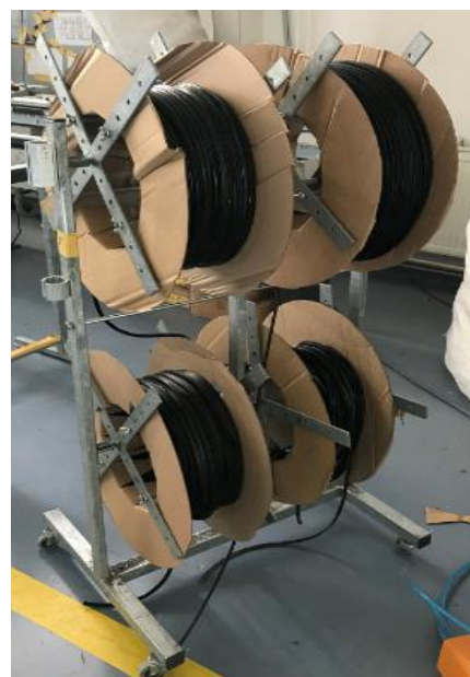
Obr. 1.16 Pojízdné zásobníky s těsněním.
