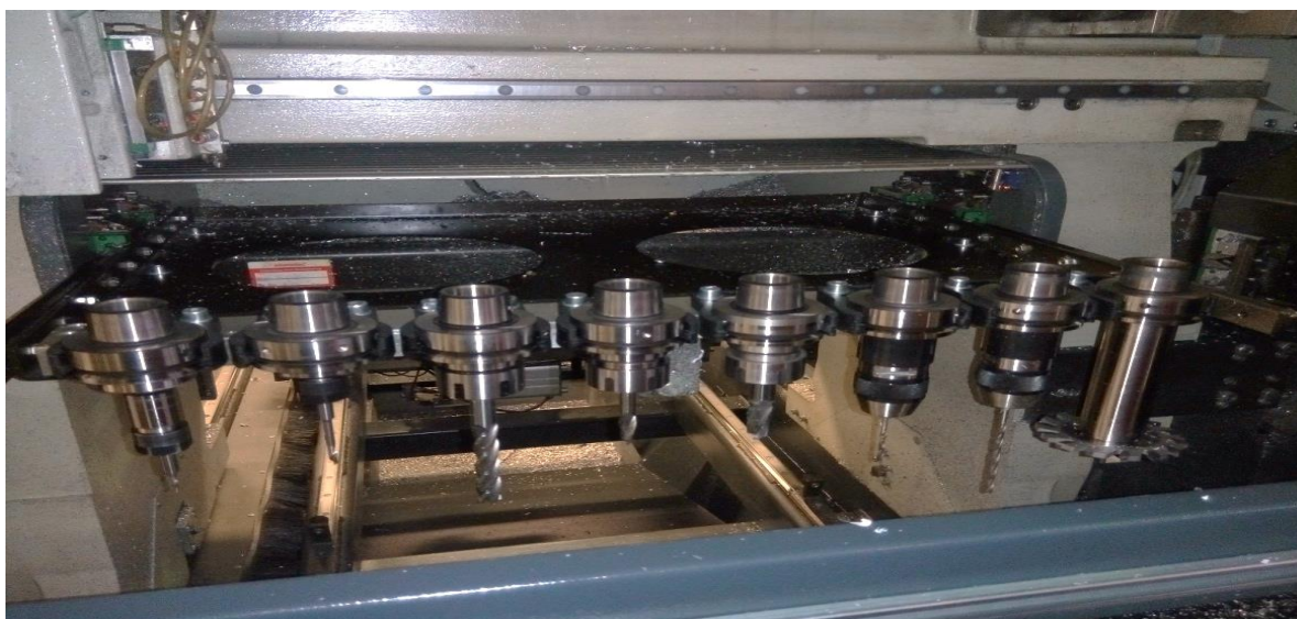
Obr. 4.2 Původní skladba nástrojů, zleva: HSS fréza \varnothing 3 mm, SK fréza \varnothing 5 mm, SK fréza \varnothing 16 mm, HSS fréza \varnothing 10 mm, HSS fréza \varnothing 8 mm, vrták \varnothing 3,5 mm, vrták \varnothing 4,5 mm, kotoučová fréza.
