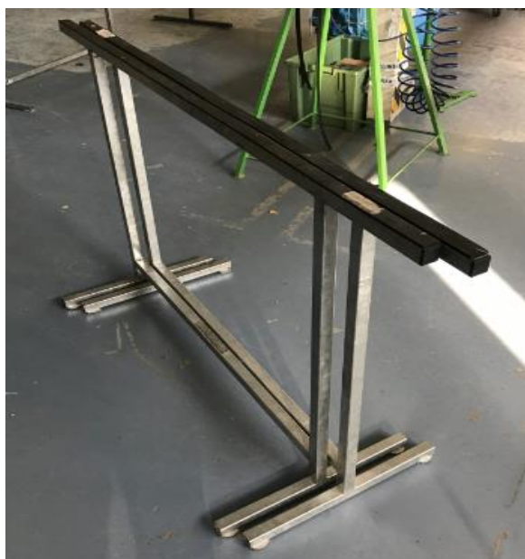
Obr. 1.15 Kovové podpěry pro stabilizaci prvku.
