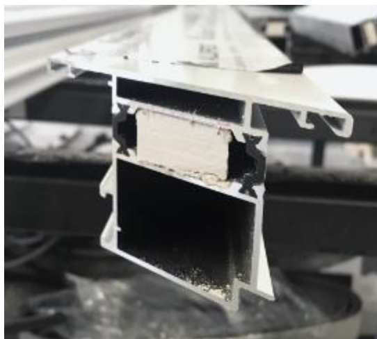
Obr. 1.31 Náhled profilu s protipožární výplní.
