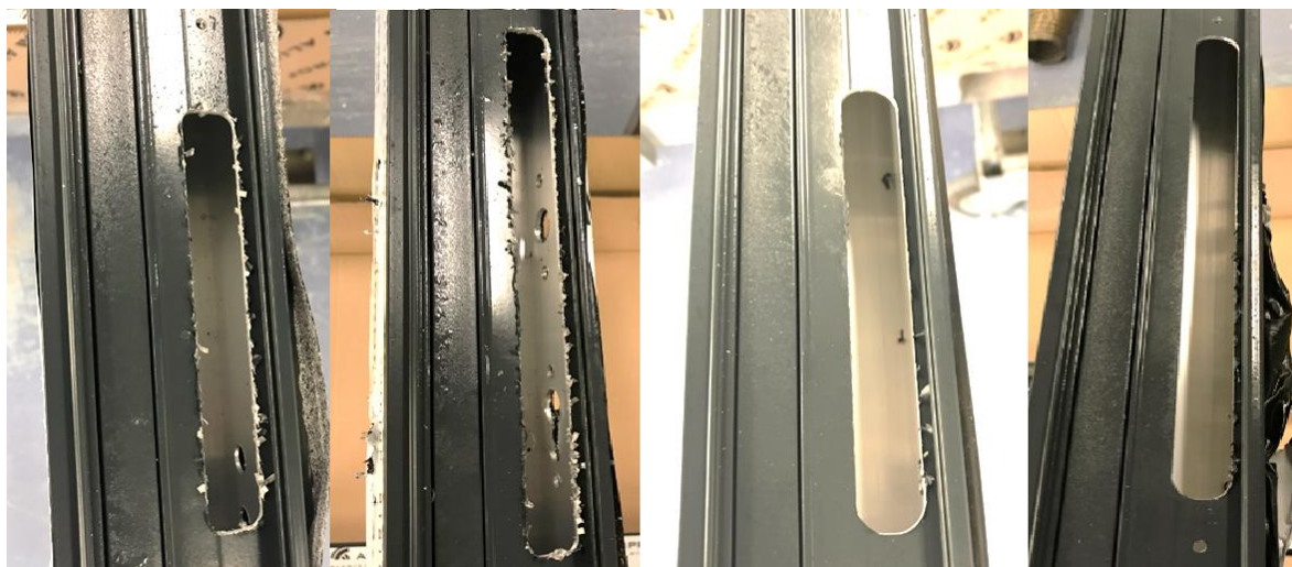
Obr. 4.10 Otvory pro osazení střelkových uzávěrů, vlevo využití původního nástroje, vpravo nového nástroje.
