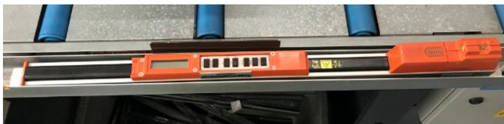
Obr. 1.17 Elektronická měřicí tyč.
