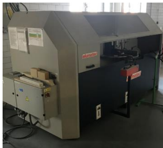
Obr. 1.12 Vyřezávací pila Elumatec AKS 134.
