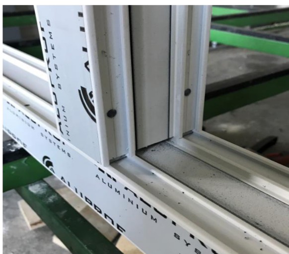
Obr. 1.13 Princip osazení profilů dělených na 90 °.
