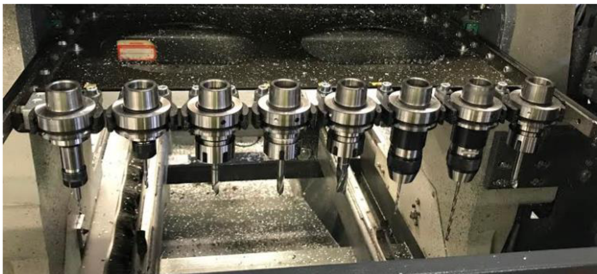
Obr. 4.3 Nová skladba nástrojů, zleva: HSS fréza \varnothing 3 mm, SK fréza \varnothing 5 mm, SK fréza \varnothing 10 mm, HSS fréza \varnothing 10 mm, SK fréza \varnothing 16 mm, vrták \varnothing 3,5 mm, vrták \varnothing 4,5 mm, SK fréza \varnothing 10 mm dlouhá.
