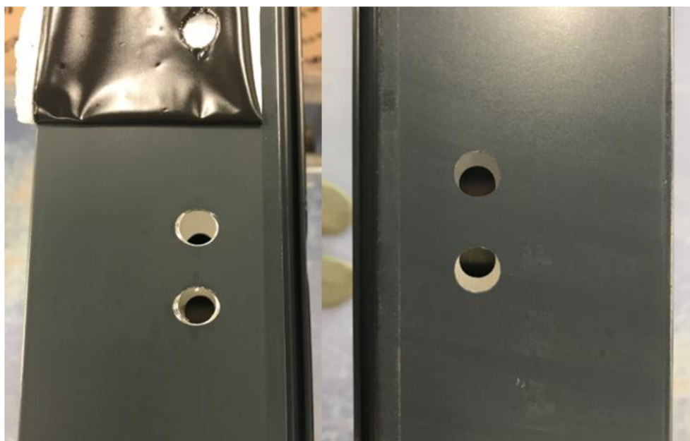
Obr. 4.8 Otvory pro osazení dveřních závěsů, vlevo využití původního nástroje, vpravo nového nástroje.
