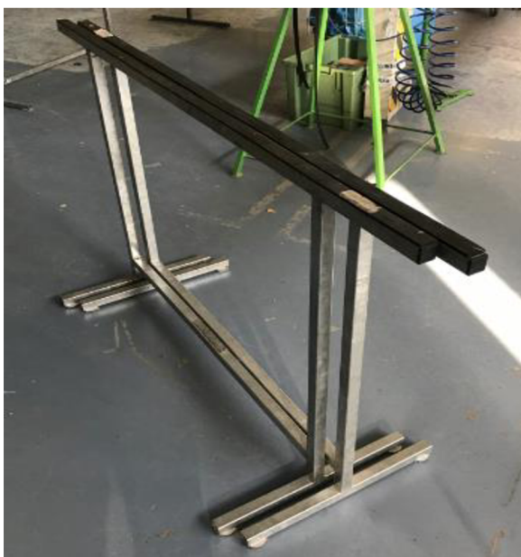
Obr. 1.15 Kovové podpěry pro stabilizaci prvku.
