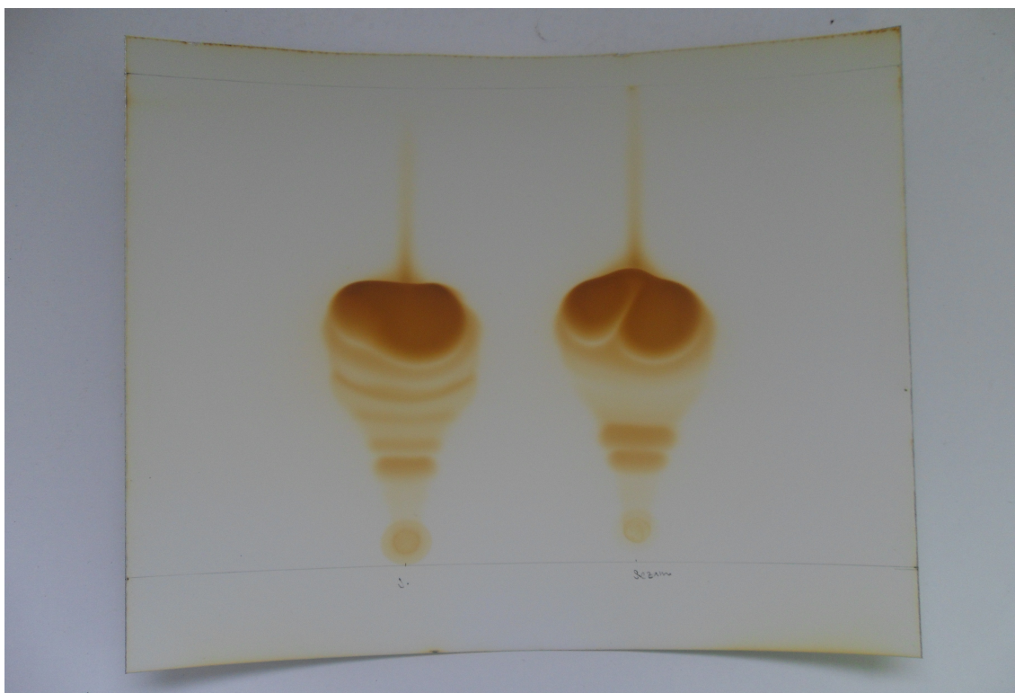
Obr. 17: Chromatograf: Olej z jablečných a sezamových semen (Zdroj vlastní)
