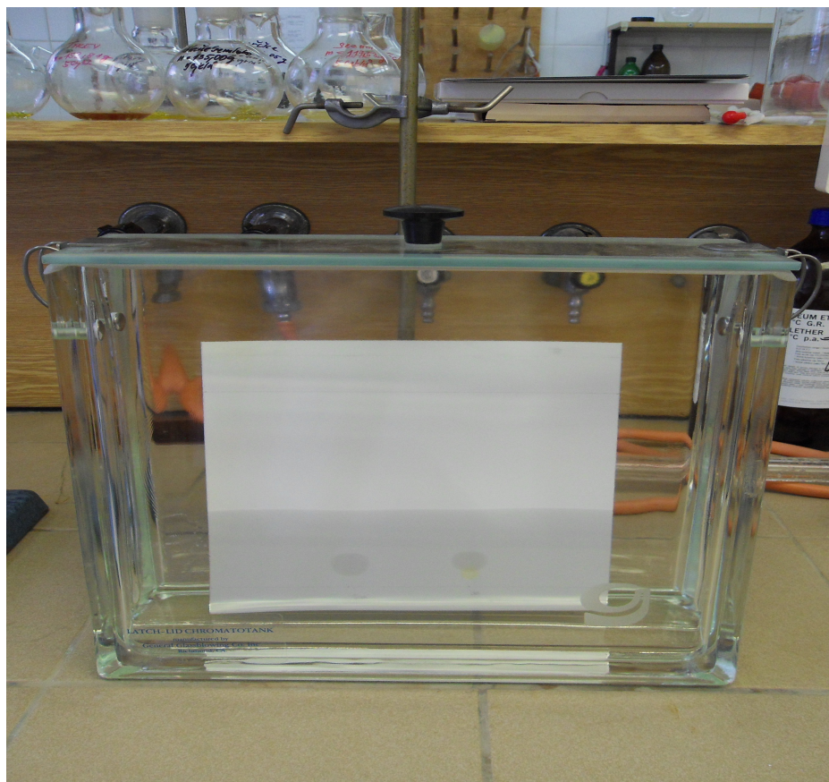
Obr.18: Chromatografická vana a vyvíjení soustavy (Zdroj vlastní)
