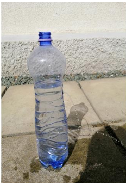
Obr. 47 – Voda vytéká pod různým tlakem
