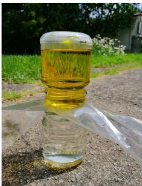
Obr. 63 – Teplá voda (obarvená na žluto) je od studené vody oddělena folií
