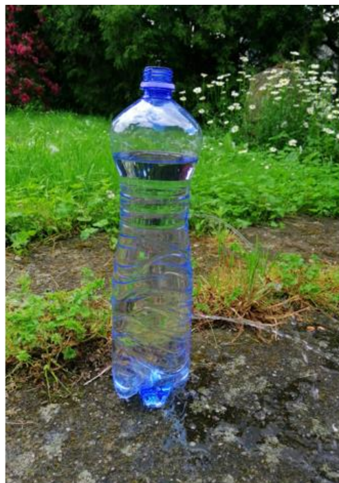
Obr. 48 – Čím vyšší sloupec vody je nad otvorem, tím je tlak vody větší
