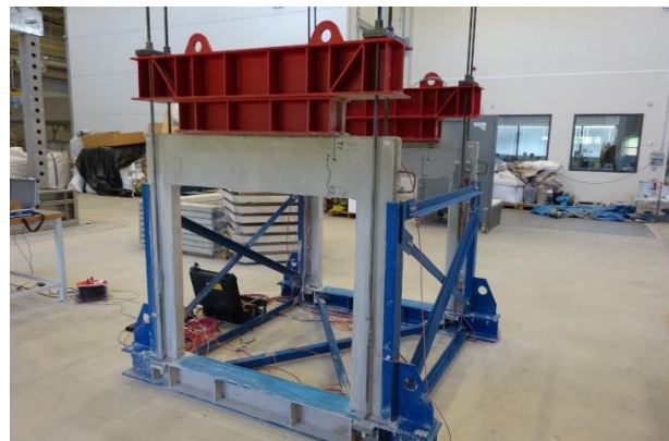
Obr. 4.2 Foto experimentu – po vyřezání otvoru
