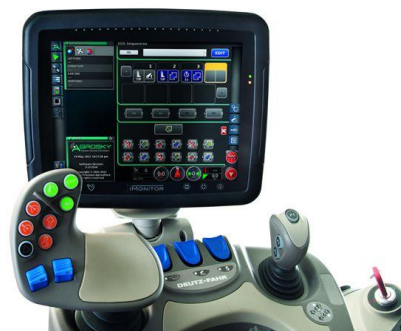
Obrázek 25 - iMonitor 2 s multifunkční ovládací pákou [25]
