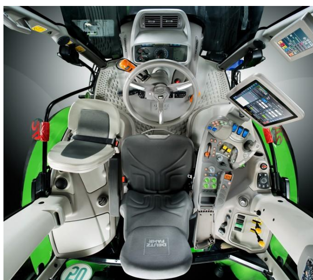
Obrázek 24 - Plošný pohled do kabiny MaxiVision [24]
