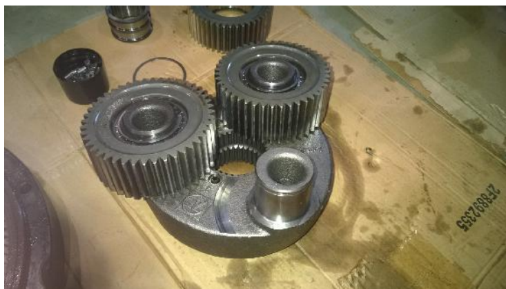
Obrázek 13 - Poškozené soukolí unašečů
