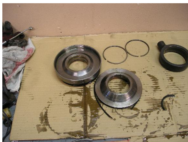
Obrázek 16 - Utěšňující kroužky s rozdrčeným těsněním
