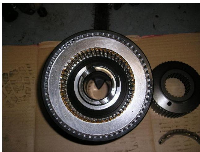
Obrázek 15 - Spojkový koš s lamelami
