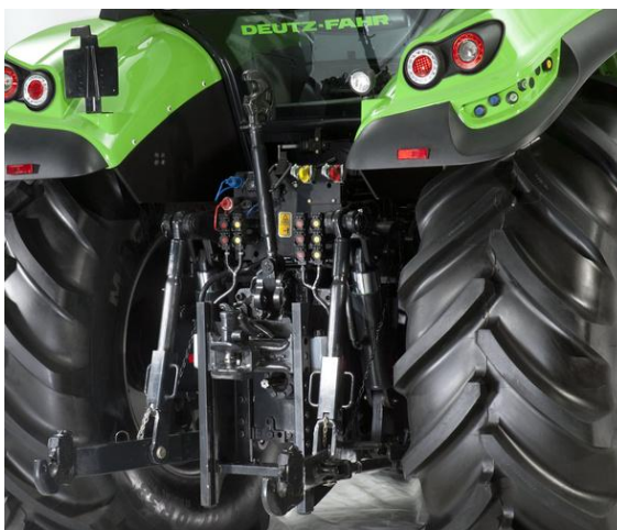
Obrázek 23 - Tříbodový závěs s vnějšími okruhy hydrauliky [23]
