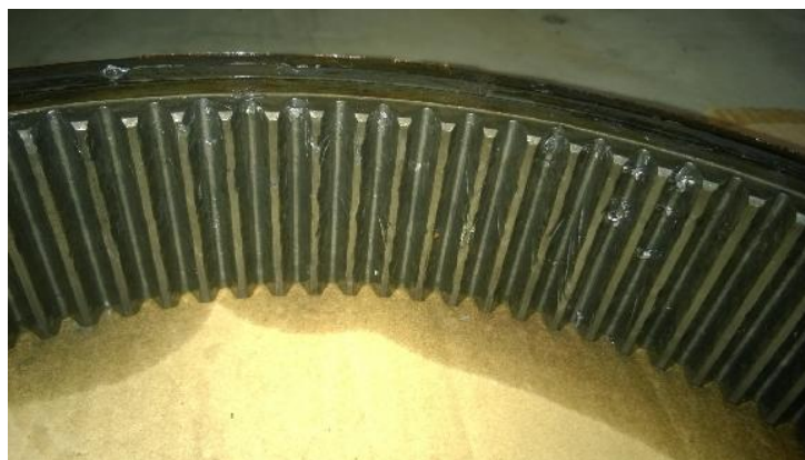
Obrázek 14 - Poškozené vnitřní ozubení koncového převodu
