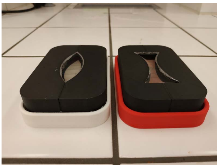
Obrázek 44: Složené plastové formy naplněné želatinou.
