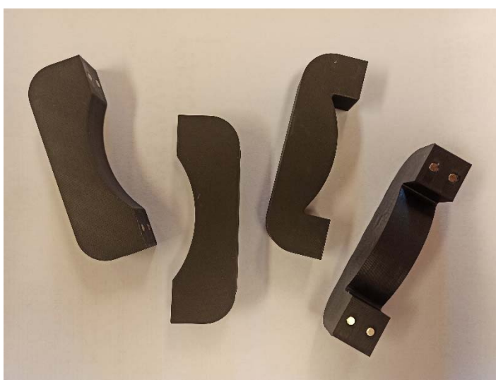
Obrázek 43: Rozložené plastové formy z 3D tiskárny.
