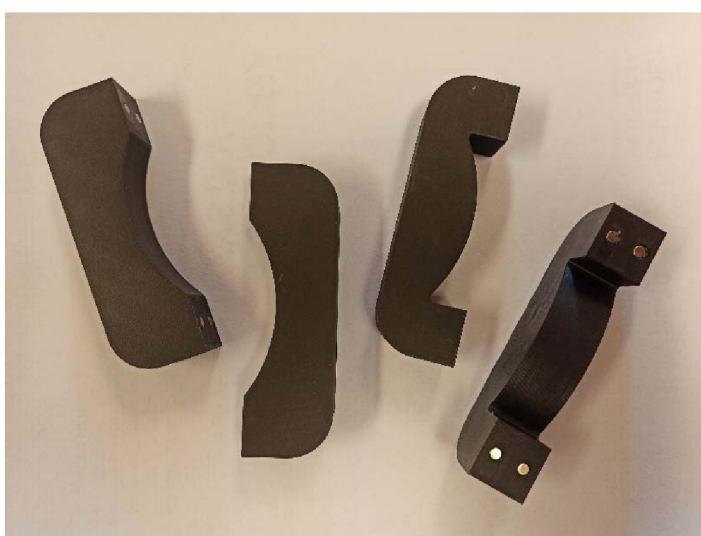
Obrázek 43: Rozložené plastové formy z 3D tiskárny.
